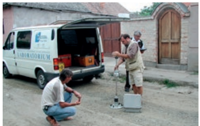
Pásztó, csatornázás - tömörségvizsgálat - 2004.
